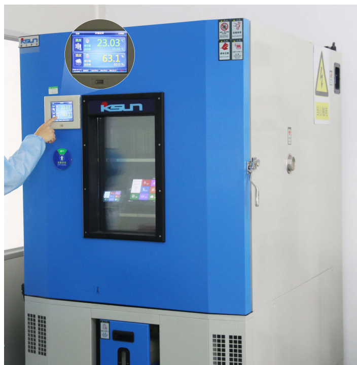
图 5-8 高低温老化测试图
